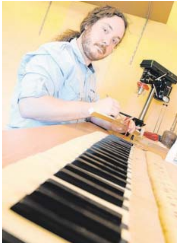
Der Vorgang der Tasten-Garnierung soll verhindern, dass die Klaviertasten in ihrer Halterung hin- und herrutschen. Foto: Ingo Otto
